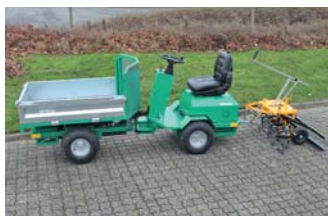
STAMA Mini Truck 24 V AC-Motor mit Knicklenkung, Heckantrieb, Zuladung bis 750 kg. Abb. mit Wegehobel
