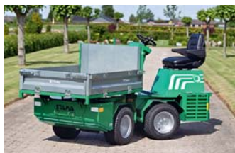
STAMA Maxi Truck 48 V AC-Motor mit Allradantrieb und Knicklenkung, Zuladung bis 1500 kg
