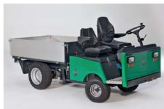
EVO-L Minikipper 48 V Heckantrieb, Zuladung 1400 kg mit 3-Seiten-Kipper
